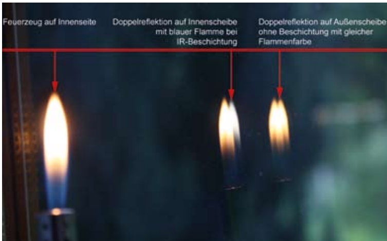
4 Flammentest zur Ermittlung von IR-Beschichtungen
